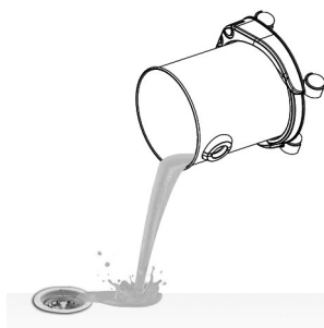
Fig. 12 – Removiendo el líquido del reservorio
