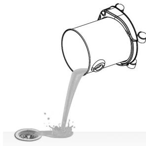
Fig. 12 – Removendo o líquido do reservatório
