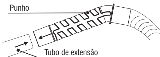
Fig. 5 – Conectando o punho no tubo de extensão
