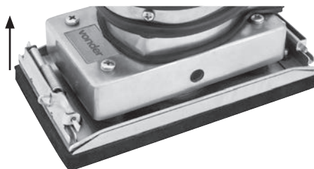
Fig. 2 – Instalação da lixa
