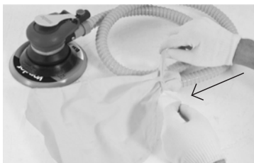
Fig. 5 – Almacenamiento del polvo
