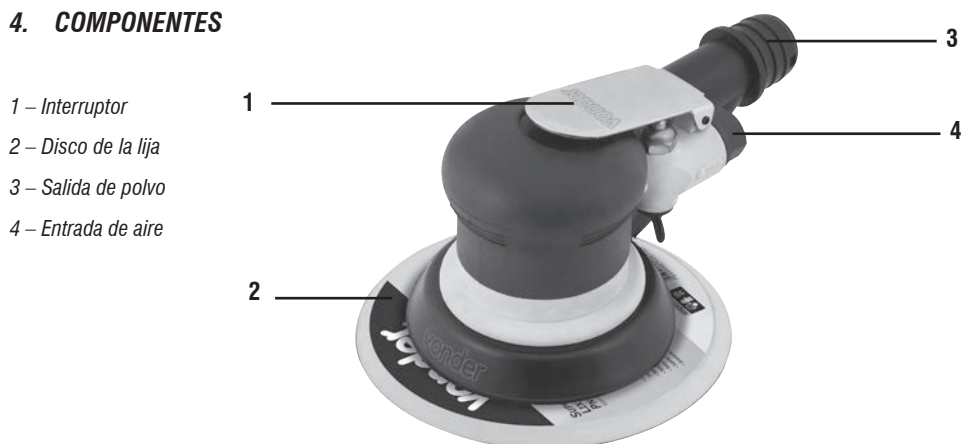
Fig. 1 – Componentes de la herramienta
