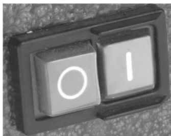
Fig. 5 – Interruptor de acionamento eletromagnético
