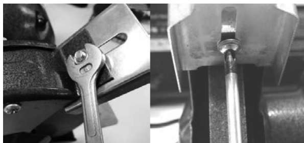
Fig. 2 – Montagem do Visor de Proteção
