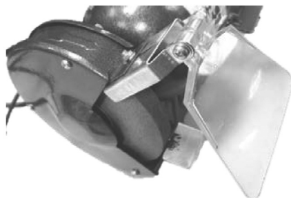
Fig. 3 – Regulagem do Visor de Proteção
