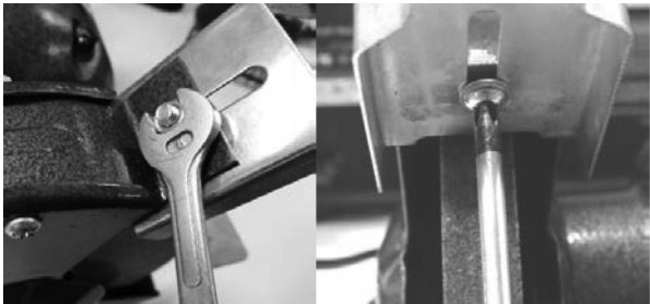
Fig. 2 – Montaje del visor de protección
