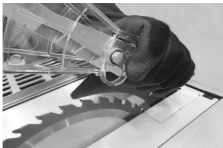
Fig. 13 – Trava de proteção da serra
