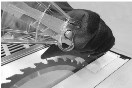
Fig. 13 – Traba de la protección de la sierra
