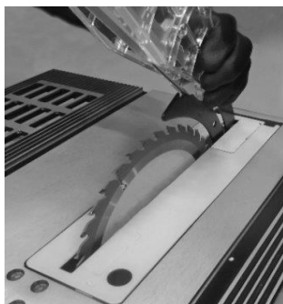
Fig. 12 – Montando la capa de protección
